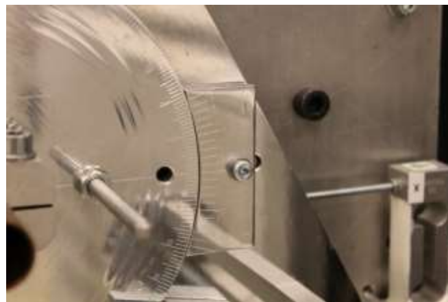
12. ábra: szögállítás tized pontos osztásközzel
