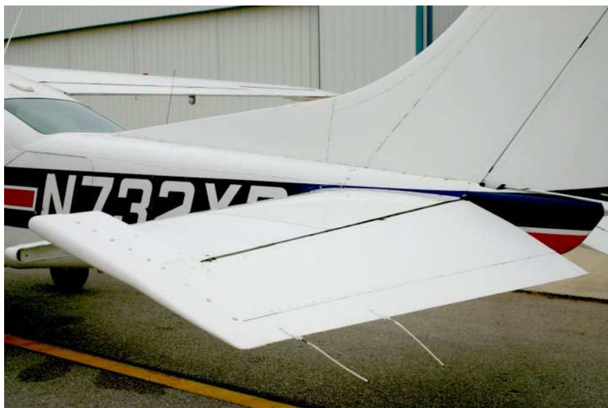
V.1. ábra: Tömegkiegyenlített magassági kormánylap
